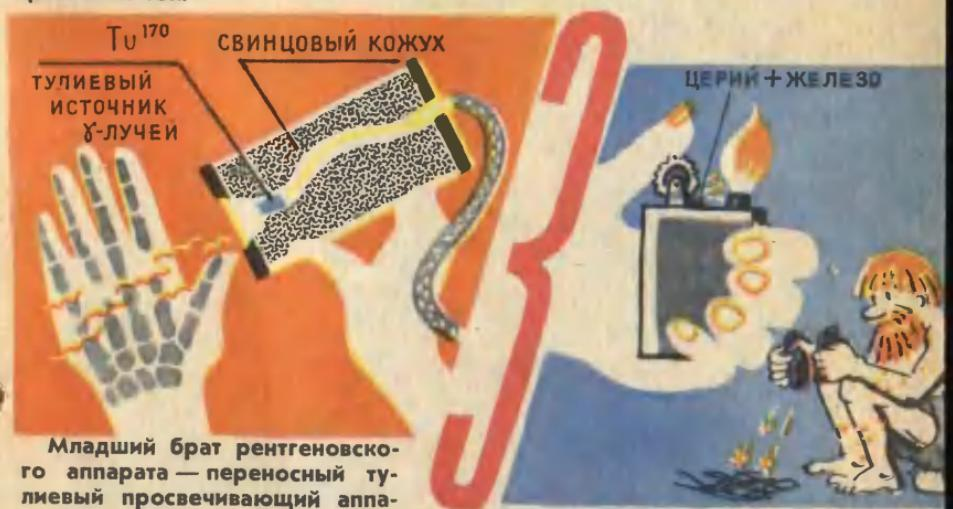
Младший брат рентгеновского аппарата — переносный тулевый просвечивающий аппарат.
