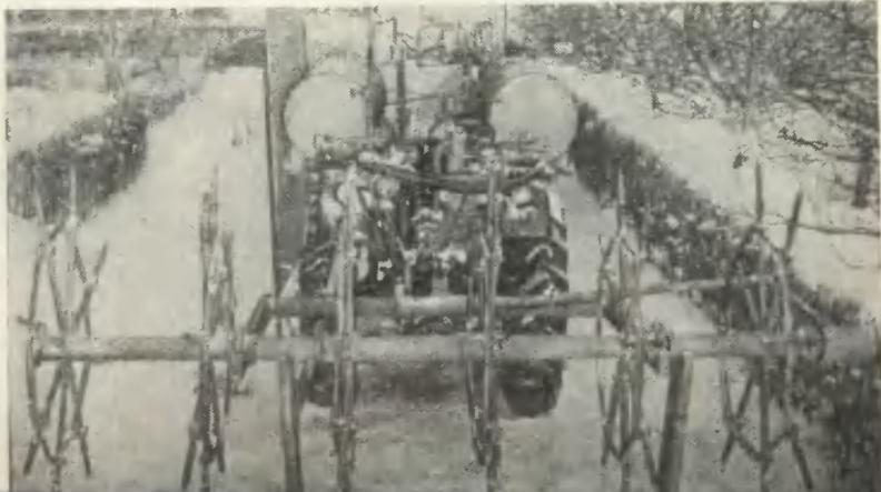
ся на трактор «Беларусь». Длинные спицы — это гидробуры. Когда ротор вращается, они, словно шприцы, вонзаются в почву. На конце каждого бура клапан, как у шариковой авторучки, а внутри бура — вода. Гидробур углубляется в землю, вода давит на шарик, и он открывает ей путь. Вода с силой бьет в землю и, размывая ее, бурит скважину. Одновременно машина орошает скважину удобрениями. С помощью гидробуров можно поливать и сады.
