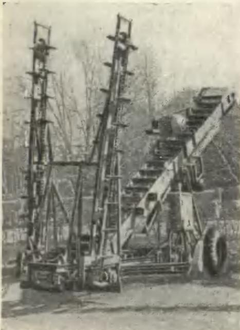
Передвигаясь на самоходной тележке, автопогрузчик захватывает полоску шириной в 4,6—6 м. Вот он подъехал к куче зерна и заглубил в него свои боковые транспортеры. Машинист включил электродвигатель, скребки транспортеров начали передвигать зерно к центральному транспортеру, поднимающему его на высоту 3 м. По дороге зерно непрерывно продувается мощным дыханием вентилятора, легкие примеси отсеиваются от тяжелых зерен.
