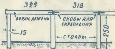
стеллажных стоек. Стеллаж устраивают над бортом на 14 стойках. Стойки, находящиеся между бортом и стеной, устанавливают до кладки борта. Их можно сделать из обрезков труб, деревянных кольев или сложить из обломков кирпичей.
