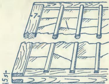
продольных брусков 160 см, ширина 7 см, толщина 5,5 см. На брусках на всю длину вынимают гнезда для шипов.
