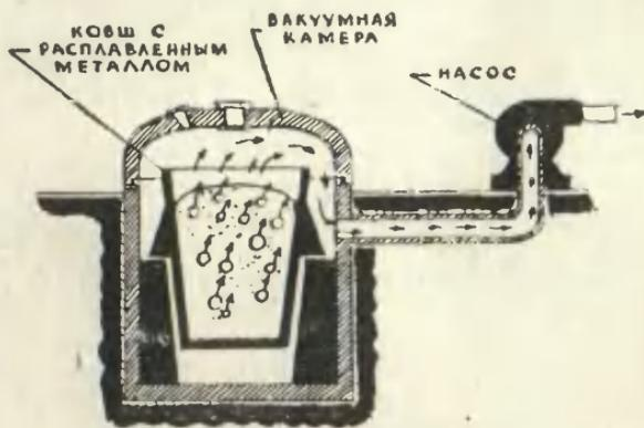
локол и насосом выкачивать воздух. При уменьшении давления начинают выделяться растворенные газы и пар: вода закипает. То же самое можно сделать с металлом.
