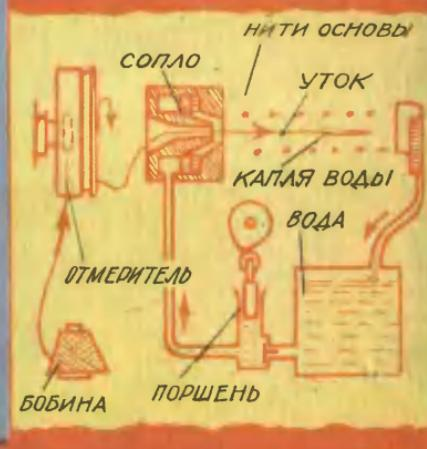
**Автоматический ткацкий станок**
