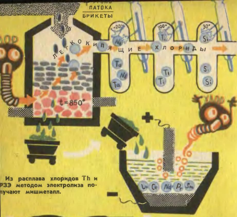
Из расплава хлоридов Тh и РЗЭ методом электролиза получают мишметалл.
